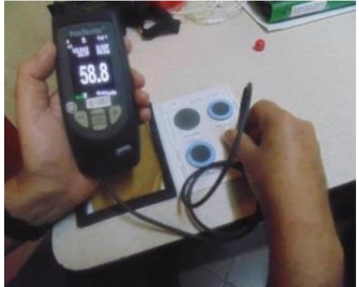
Figura 1 Lecturas individuales en Placa Recubierta (28945) ubicada en el Coating Thickness Standards. Fuente: Elaboración propia
